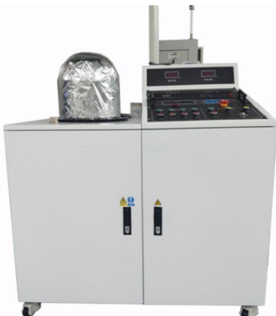
电子束蒸发可以蒸发高熔点材料，比一般电阻加热蒸发热效率高、 束流密度大、 蒸发速度快，制成的薄膜
